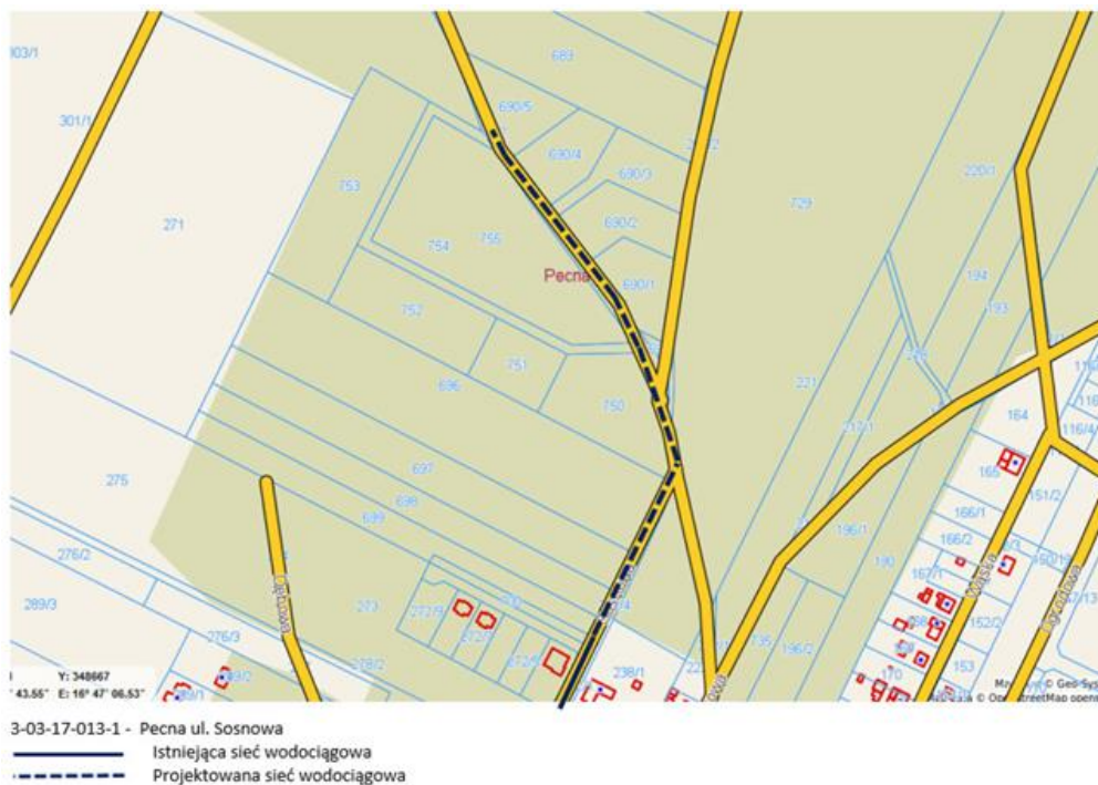
Rysunek 26. Zasięg prac na sieci wodociągowej w ul. Sosnowej w Pecnej. źródło: AQUANET S.A.
