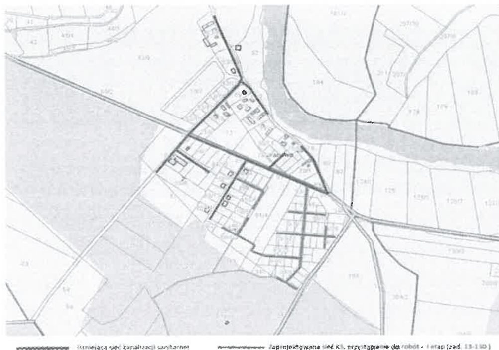
Rysunek 31. Zasięg prac na sieci kanalizacyjnej w części wsi Baranowo. źródło: AQUANET S.A.
