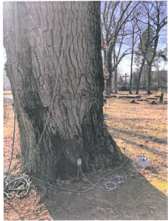
FOT. 1.2. TEST OBCIĄŻENIOWY WYKONANO Z ZASTOSOWANIEM 4 ELASTOMETRÓW I 2 INKLINOMETRÓW.
