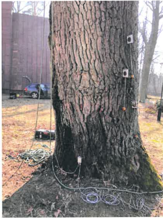
FOT. 1.1. TEST OBCIĄŻENIOWY. UMIEJSCOWIENIE CZUJNIKÓW
